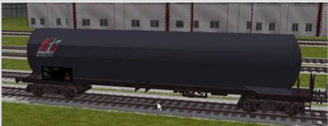
Zagkks Gas- Kesselwagen.
